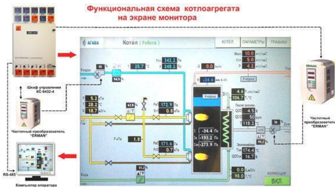
Рисунок 1 - Функциональная схема котлоагрегата на экране монитора
