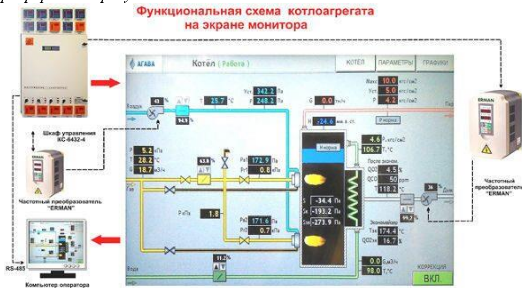
Рисунок 1 - Функциональная схема котлоагрегата на экране монитора
