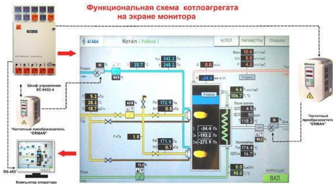
Рисунок 1 - Функциональная схема котлоагрегата на экране монитора
