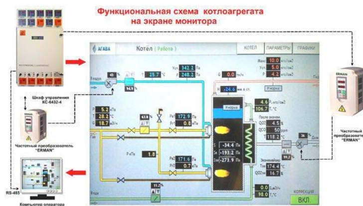
Рисунок 1 - Функциональная схема котлоагрегата на экране монитора
