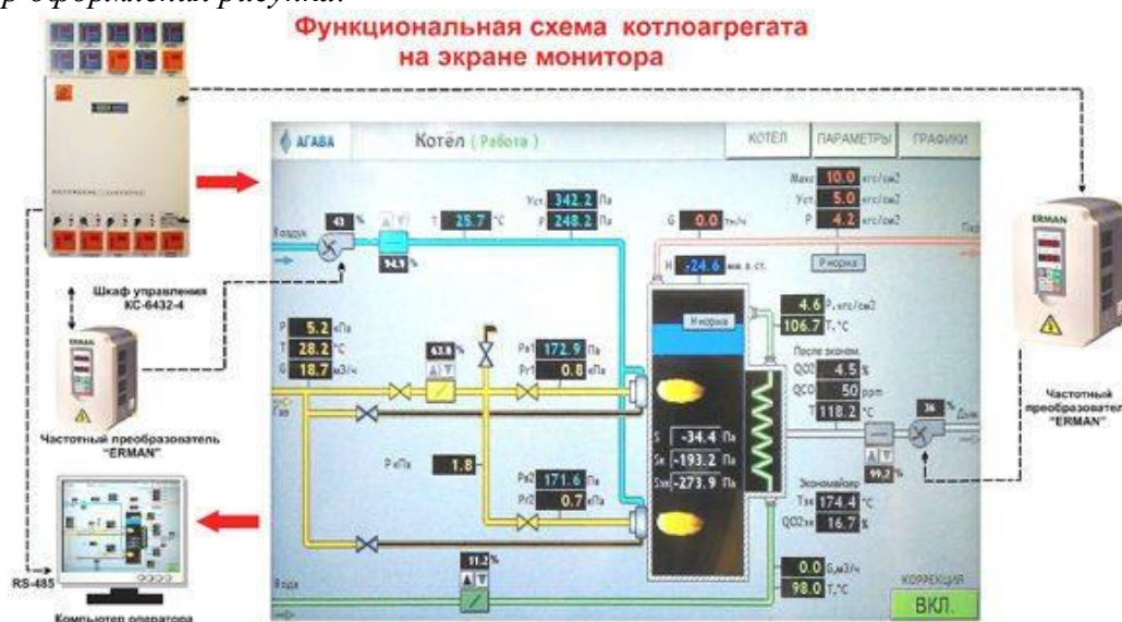
Рисунок 1 - Функциональная схема котлоагрегата на экране монитора
