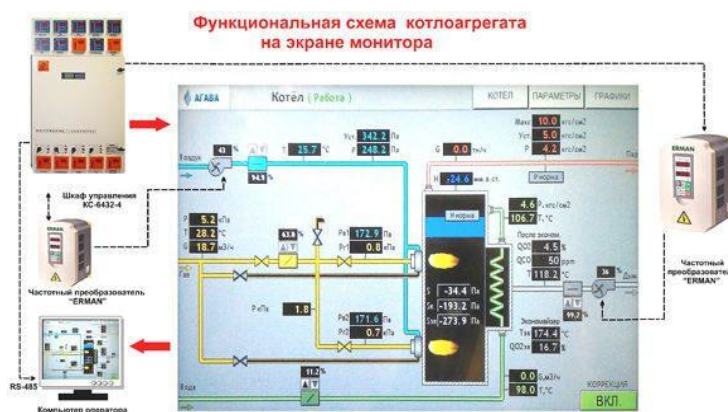
Рисунок 1 - Функциональная схема котлоагрегата на экране монитора
