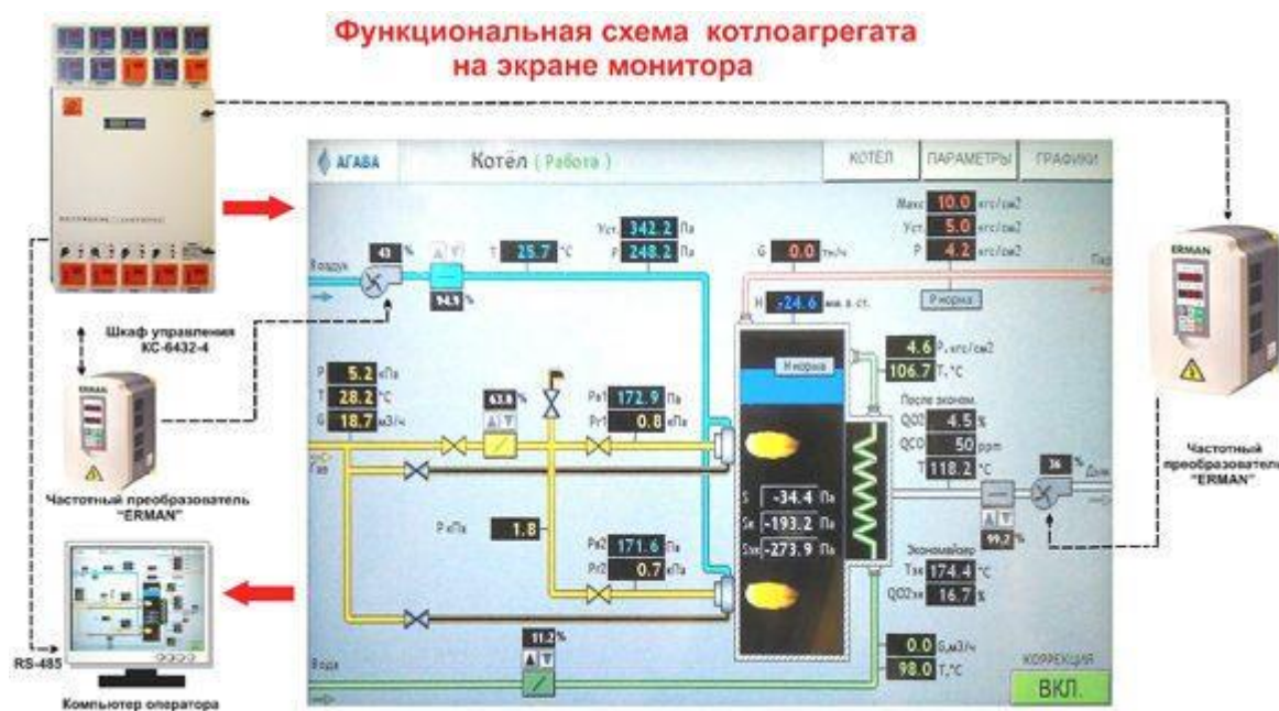
Рисунок 1 - Функциональная схема котлоагрегата на экране монитора
