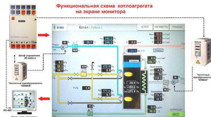
Рисунок 1 - Функциональная схема котлоагрегата на экране монитора
