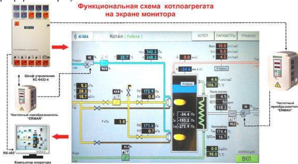
Рисунок 1 - Функциональная схема котлоагрегата на экране монитора
